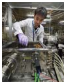
PF BL-13Aに常設されているコンパクト走査型透過軟X線顕微鏡。
