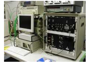
フーリエ分光法と強磁場磁石を組み合わせたテラヘルツ分光システム (左)、サブミリ波送受信システム (右)
