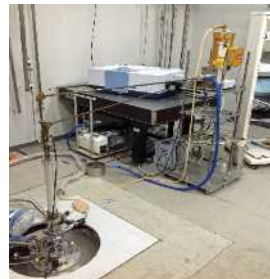
フーリエ分光法と強磁場磁石を組み合わせたテラヘルツ分光システム (左)、サブミリ波送受信システム (右)
