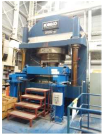
大型ベルト装置による 難窒化物合成と実用大 焼結体作成
