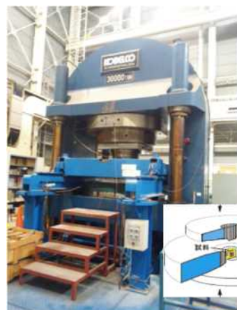
3万トンベルト型高圧装置@NIMS (左) 高圧試料容器構成 (右)
