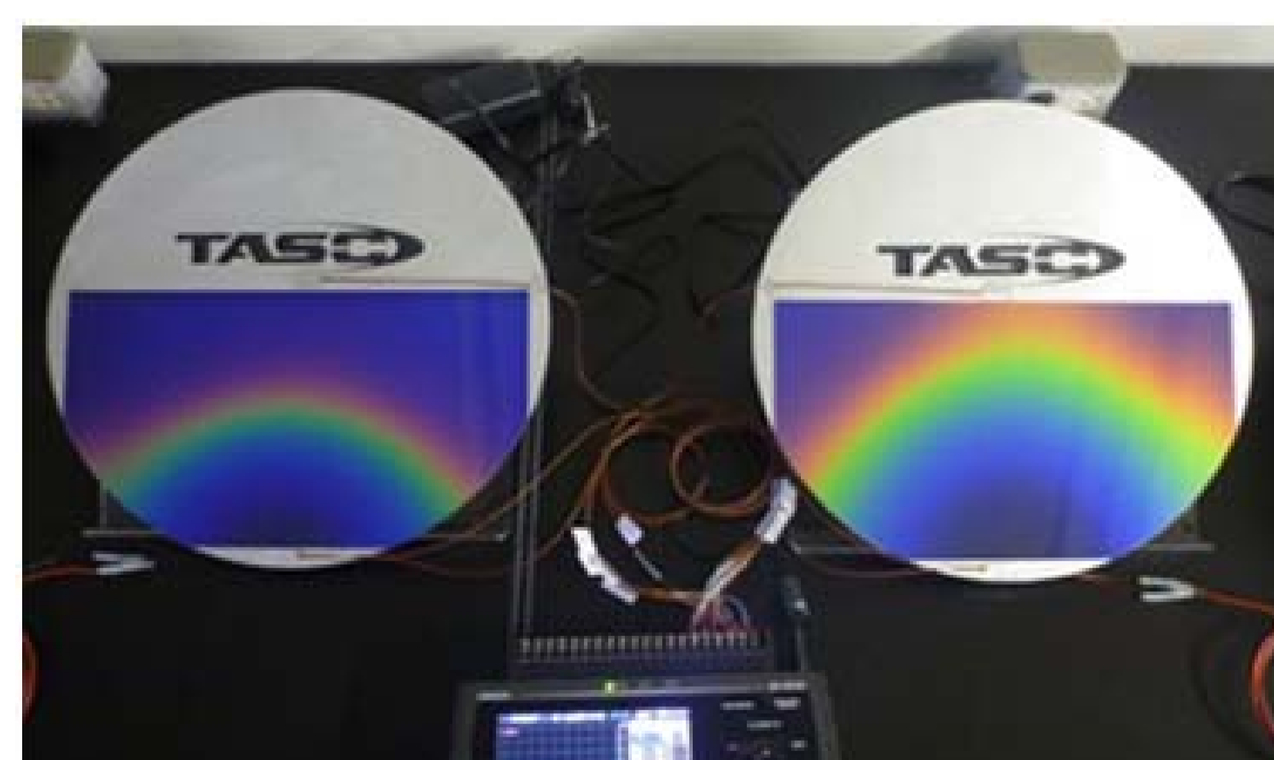
電熱試験(左:アルミニウム、右:開発材)
