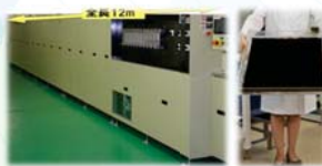
スーパー臨界法によるSWCNTの工業的量产技術 ※大面積連続合成炉
