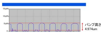
マイクロバンプの測定結果
