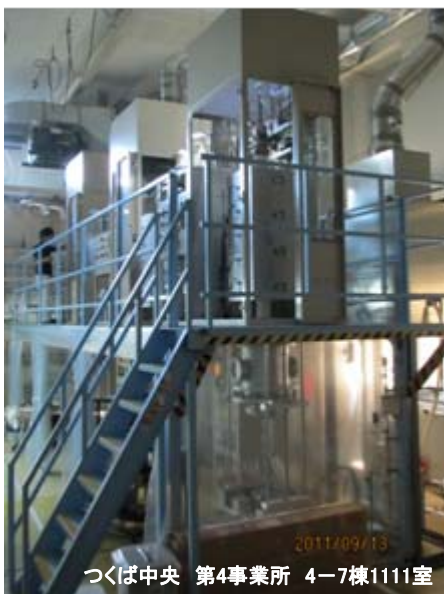
eDIPS法単層CNT合成装置 直径制御した単層CNTの光吸収スペクトル
