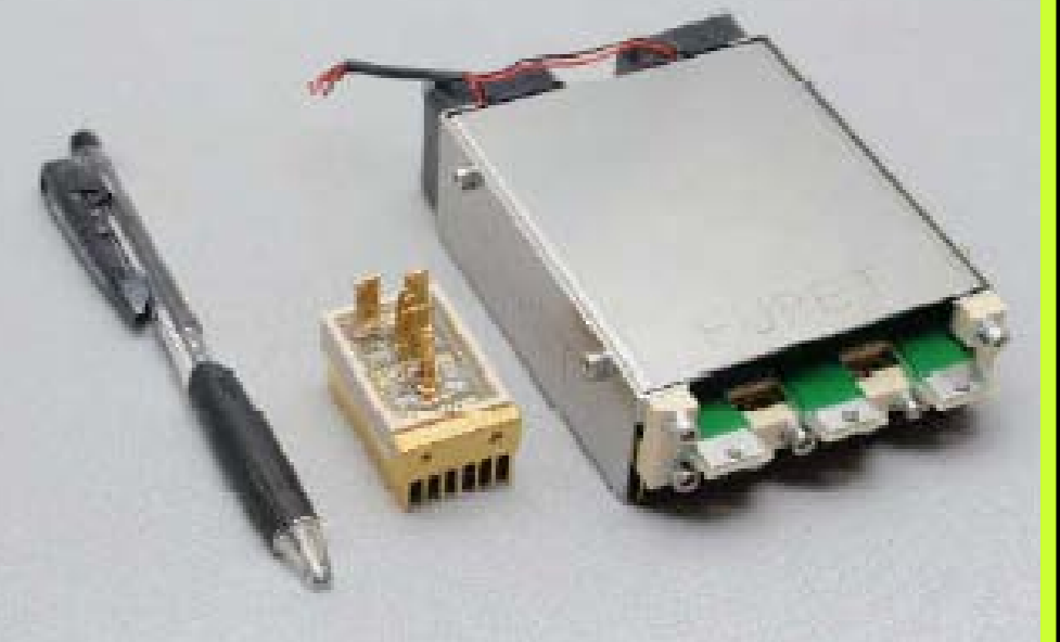
10kW all-SiCインバータの試作器(右端)と パワーモジュール(中央) 出力パワー密度: 40W/cm 3 (10kW/250cm 3 )
