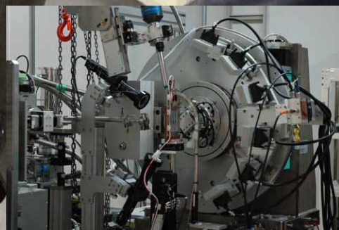
高分解能粉末X線回折装置 (BL15XUビームライン, SPring-8) High-precision powder X-ray diffractometer (BL15XU beamline, SPring-8)
