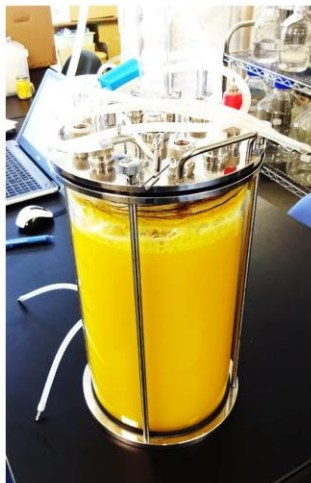
専用培養装置による培養 (9L)
