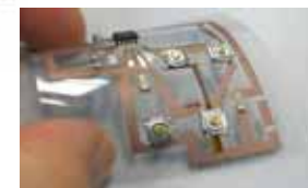
低温焼結のため基材のダメージがなく電子デバイスの形成が可能
