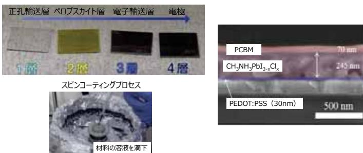
本プロセスにより、プラスチックなどのフレキシブルな基板を用いた太陽電池の製造が可能。
