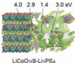
リチウムイオンの欠乏層形成につながるリチウムサイトを空孔形成エネルギーの計算から推定。
