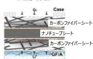
CFシートでCNTシートを挟むという新たな発想により、セルの超高容量化を実現（現行LIBの約15倍！）
