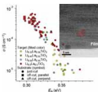
材料創製と計測の立場から結晶成長と欠陥構造の相関を調べ、伝導の活性化工エネルギーを0.3 eVに低減。
