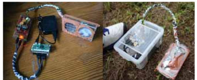
図1 携帯型土壌汚染測定器試験機(左)とその測定風景(右)
