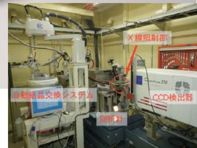
タンパク質結晶構造解析装置: 結晶化したタンパク質の立体構造を調べることができます。
