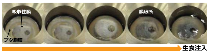
図5 疎水化ゼラチン吸収性膜を用いた耐圧強度試験の様子
