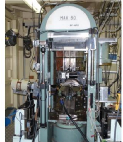
高圧X線回折装置(MAX80) による高圧下観察
