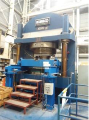
大型プレスによる結晶・焼結体合成
