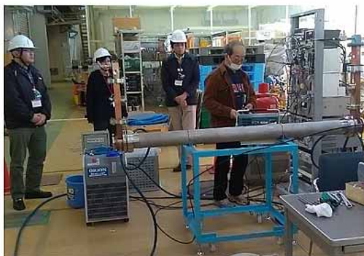
(小型加速器実習: クライストロンから加速管パワー投入+ネットワークアナライザによる電磁波計測)
