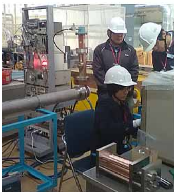
(小型加速器実習: クライストロンから加速管パワー投入+ネットワークアナライザによる電磁波計測)
