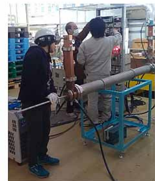
(小型加速器実習: クライストロンから加速管パワー投入+ネットワークアナライザによる電磁波計測)
