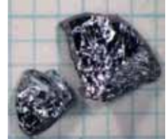
図 2 高圧で溶融凝固した \text{MoS}_2 結晶
