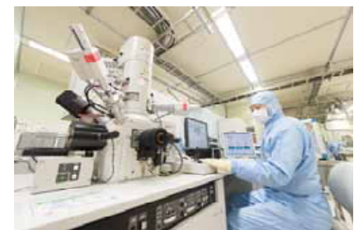
集束イオンビーム加工観察装置 Focused Ion Beam Microscopy and Micromachining
